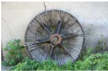
Koło napędowe z drewnianymi zębami młyna w Dziadoszynie
